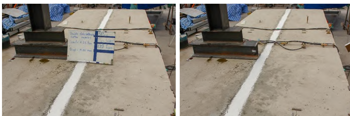
รูปที่ 5.2-16 การทดสอบชิ้นส่วนสะพานสำเร็จรูปคู่แบบสถิติภายหลังการเสริมกำลังด้วยแถบยางพาราอัดแรง ขณะเกิดการแอ่นตัวที่ 4 มิลลิเมตร
