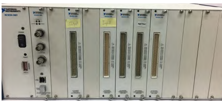
รูปที่ 4.7-4 อุปกรณ์แปลงสัญญาณ A to D (Data Logger)
