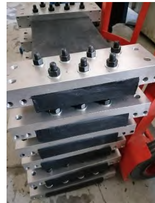
รูปที่ 3.2-2 แผ่นยางพาราที่เจาะรูและประกอบโดยการขันน็อตยึดติดกับ Rubber Grip
