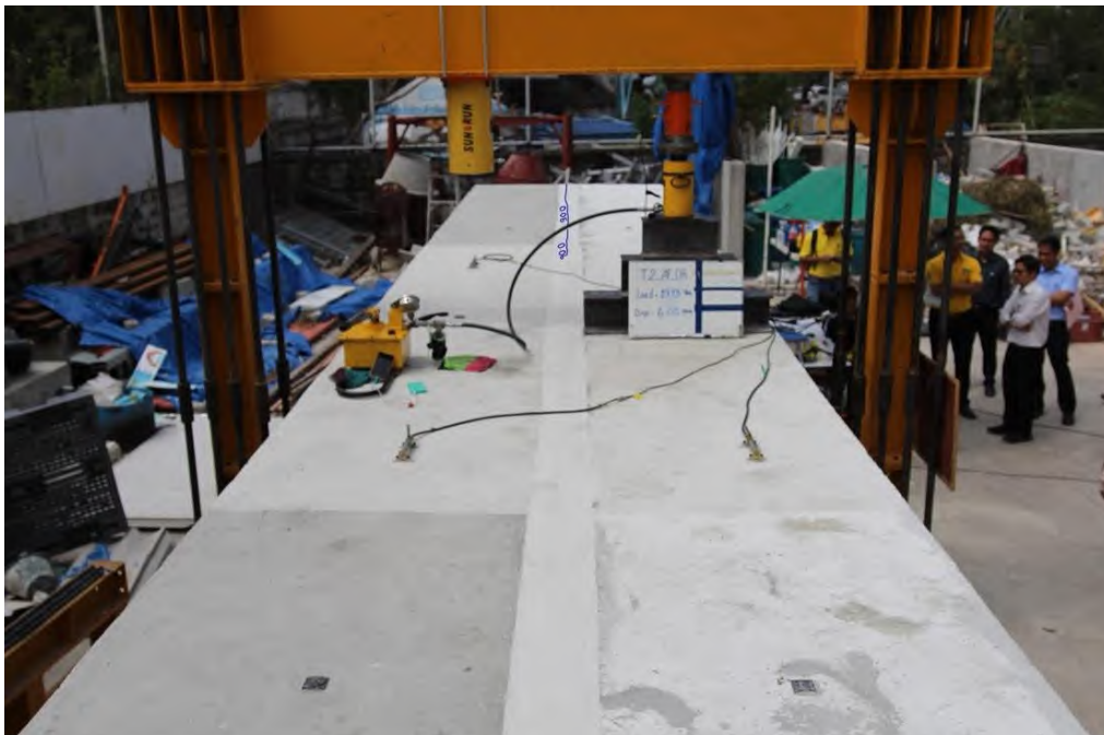
รูปที่ 5.4-38 RC T-Girder แบบระบบคาน หลังเสริมกำลัง ขณะเกิดการแอ่นตัวที่ 6.00 มิลลิเมตร
