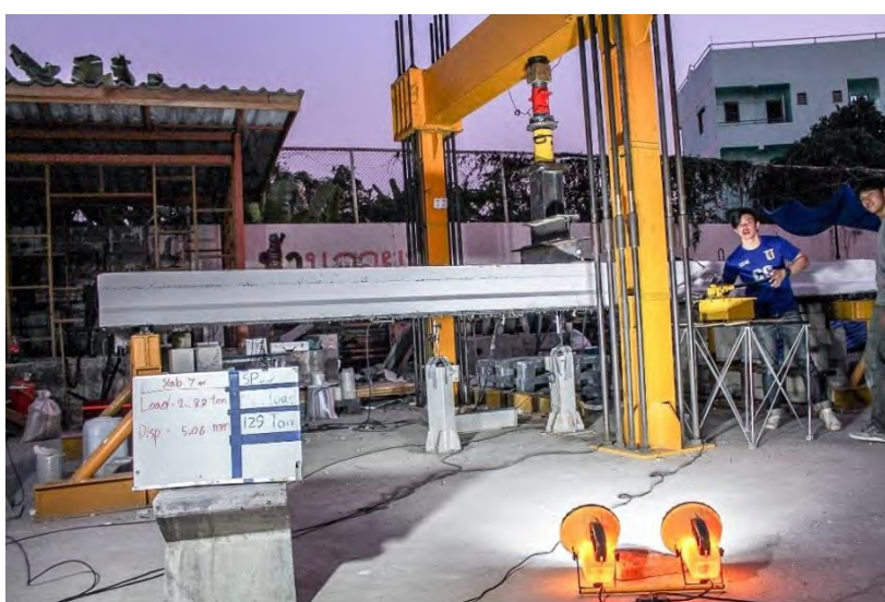
รูปที่ 5.1-6 การทดสอบชิ้นส่วนสะพานสำเร็จรูปเดี่ยวแบบสลิตก่อนการเสริมกำลังด้วยแถบยางพาราอัดแรง ขณะเกิดการแอ่นตัวที่ 5 มิลลิเมตร
