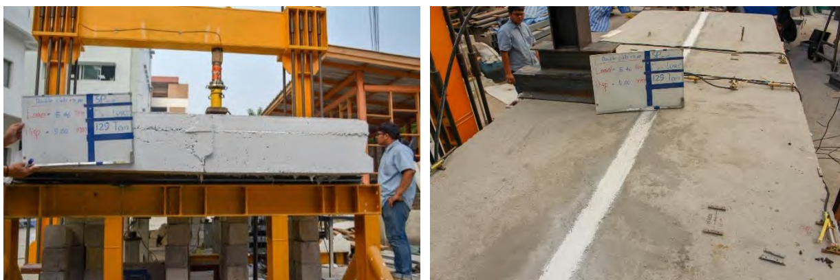
รูปที่ 5.2-5 การทดสอบชิ้นส่วนสะพานสำเร็จรูปคู่แบบสถิตก่อนการเสริมกำลังด้วยแถบยางพาราอัดแรง ขณะเกิดการแอ่นตัวที่ 5 มิลลิเมตร
