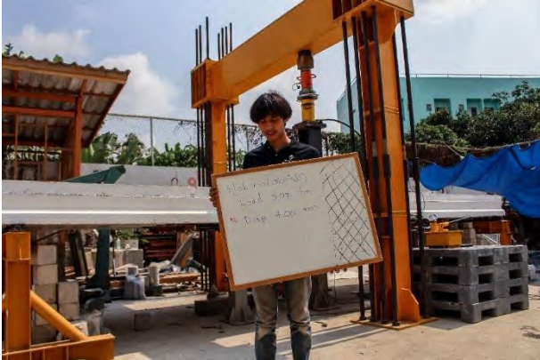
รูปที่ 5.1-18 การทดสอบชิ้นส่วนสะพานสำเร็จรูปเดี่ยวแบบสถิติภายหลังการเสริมกำลังด้วยแถบยางพาราอัดแรง ขณะเกิดการแอ่นตัวที่ 4 มิลลิเมตร
