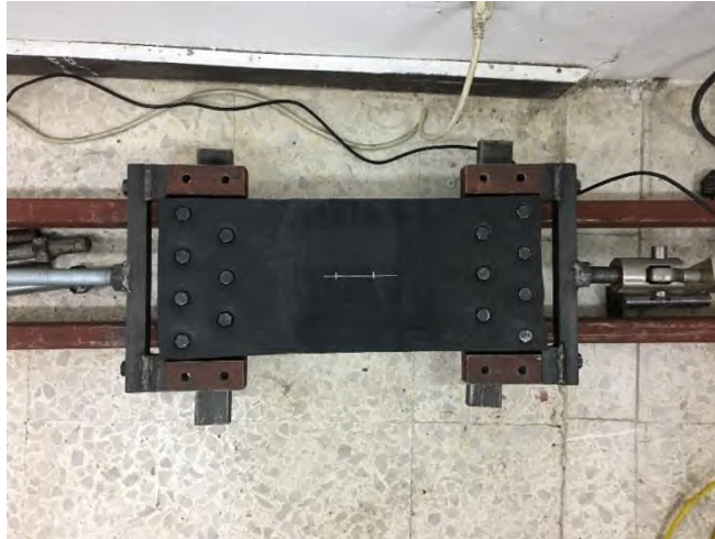
รูปที่ 3.2-3 แผ่นยางพาราประกอบเข้ากับเครื่องดึงยางเพื่อให้ยางมีแรงดึงภายในคงค้าง
