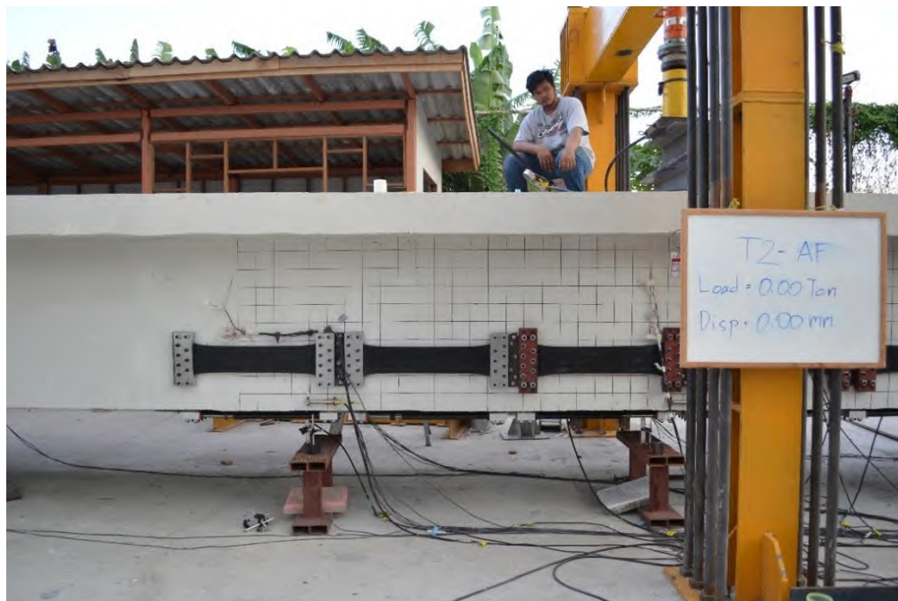
รูปที่ 5.3-23 การทดสอบชิ้นส่วนสะพาน RC T-girder เดี่ยวแบบสถิติภายหลังการเสริมกำลังด้วยแถบยางพาราอัดแรง ขณะเกิดการแ่นตัวที่ 0.00 มิลลิเมตร
