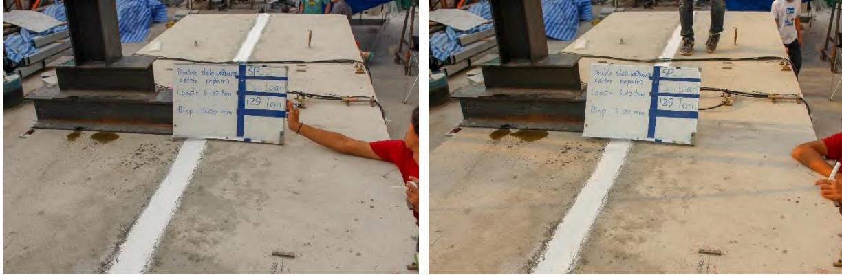
รูปที่ 5.2-17 การทดสอบชิ้นส่วนสะพานสำเร็จรูปคู่แบบสถิติภายหลังการเสริมกำลังด้วยแถบยางพาราอัดแรง ขณะเกิดการแอ่นตัวที่ 5 และ 6 มิลลิเมตร
