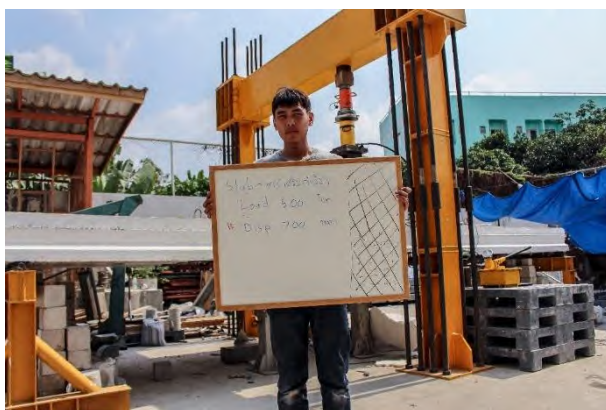
รูปที่ 5.1-21 การทดสอบชิ้นส่วนสะพานสำเร็จรูปเดี่ยวแบบสถิติภายหลังการเสริมกำลังด้วยแถบยางพาราอัดแรง ขณะเกิดการแอ่นตัวที่ 7 มิลลิเมตร
