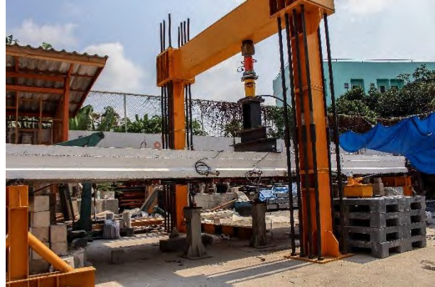
รูปที่ 5.1-18 การทดสอบชิ้นส่วนสะพานสำเร็จรูปเดี่ยวแบบสถิติภายหลังการเสริมกำลังด้วยแถบยางพาราอัดแรง ขณะเกิดการแอ่นตัวที่ 4 มิลลิเมตร
