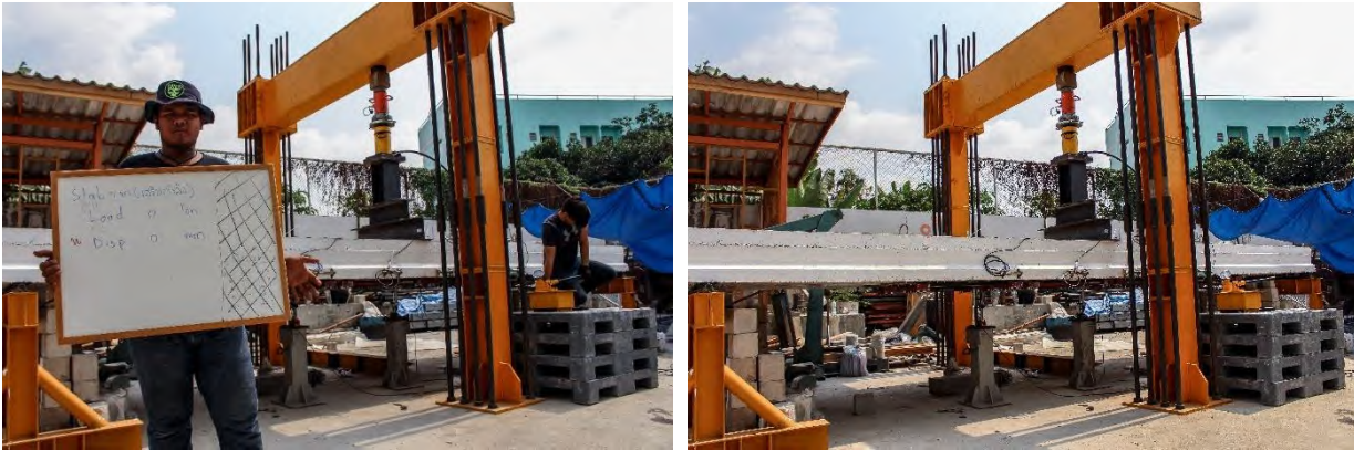
รูปที่ 5.1-14 การทดสอบชิ้นส่วนสะพานสำเร็จรูปเดี่ยวแบบสถิติภายหลังการเสริมกำลังด้วยแถบยางพาราอัดแรง ขณะเกิดการแอ่นตัวที่ 0 มิลลิเมตร
