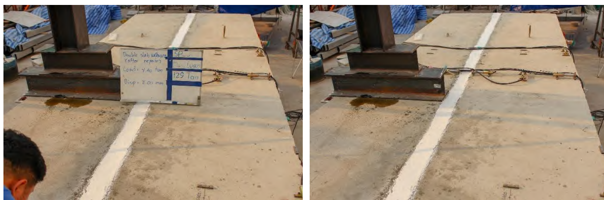
รูปที่ 5.2-19 การทดสอบชิ้นส่วนสะพานสำเร็จรูปคู่แบบสถิติภายหลังการเสริมกำลังด้วยแถบยางพาราอัดแรง ขณะเกิดการแอ่นตัวที่ 8 มิลลิเมตร
