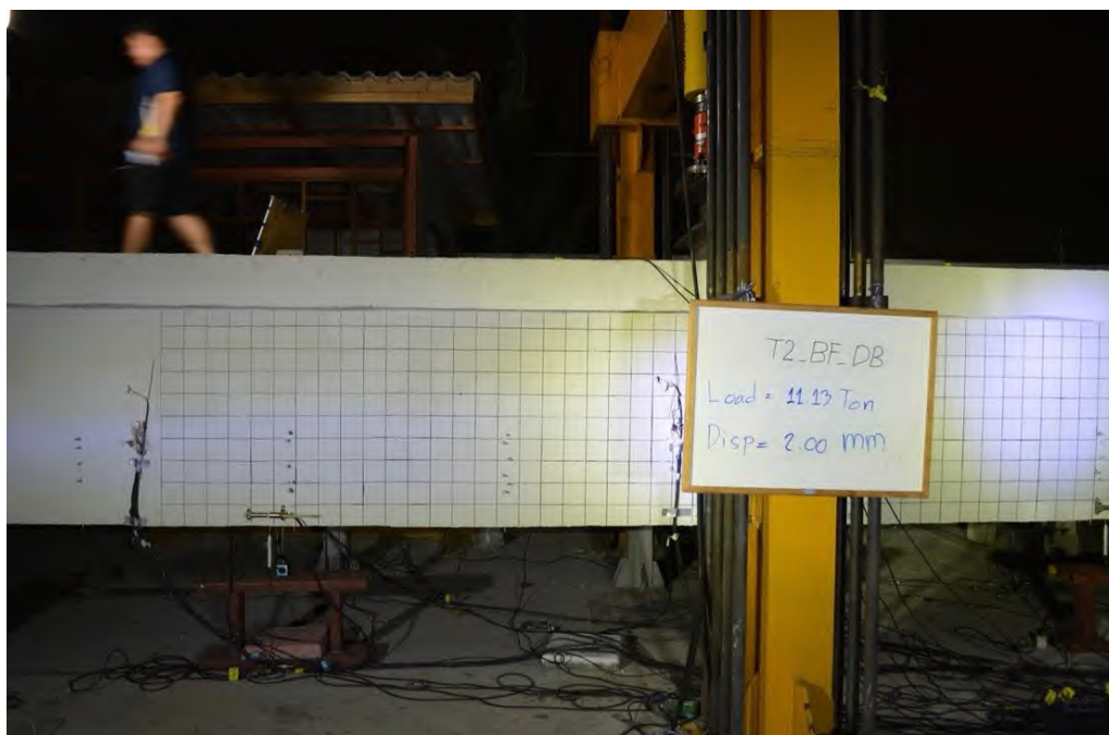
รูปที่ 5.4-3 การทดสอบชิ้นส่วนสะพาน RC T-girder แบบระบบคาน แบบสถิตก่อนการเสริมกำลังด้วยแถบยางพารา อัตราแรงขณะเกิดการแอ่นตัวที่ 2.00 มิลลิเมตร
