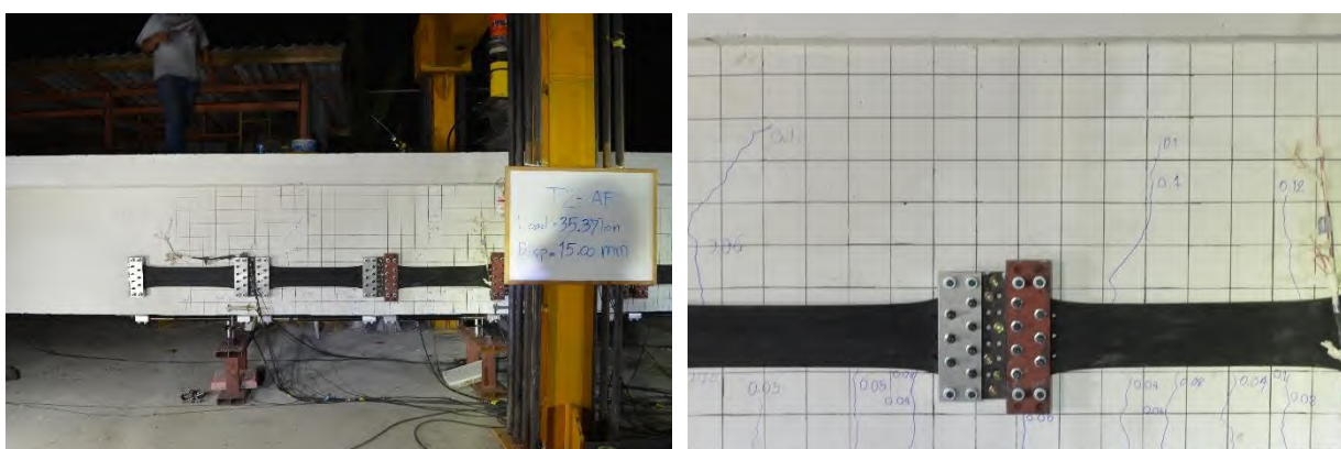
รูปที่ 5.3-40 การทดสอบ RC T-Girder เดี่ยวแบบสถิติภายหลังการเสริมกำลังด้วยวัสดุยางพารา ขณะเกิดการแอ่นตัวที่ 15 มิลลิเมตร
