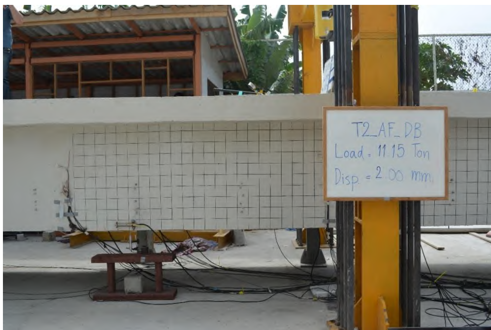
รูปที่ 5.4-24 การทดสอบชิ้นส่วนสะพาน RC T-girder แบบระบบคาน แบบสลิต หลังเสริมกำลังด้วยแถบยางพาราอัด แรงขณะเกิดการแอ่นตัวที่ 2.00 มิลลิเมตร
