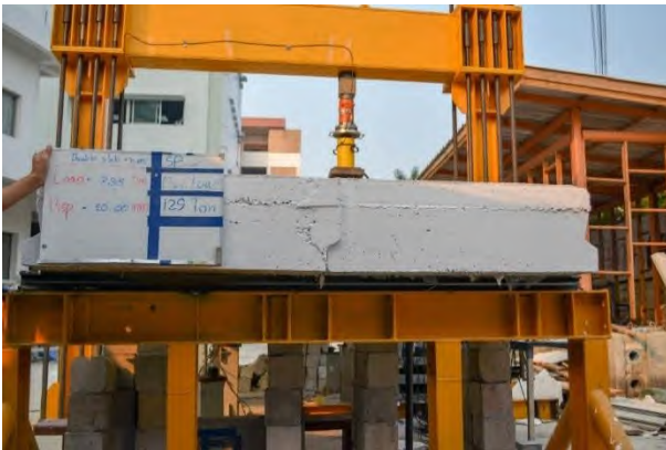
รูปที่ 5.2-13 การทดสอบชิ้นส่วนสะพานสำเร็จรูปคู่แบบสถิติภายหลังการเสริมกำลังด้วยแถบยางพาราอัดแรง ขณะเกิดการแอ่นตัวที่ 0 มิลลิเมตร
