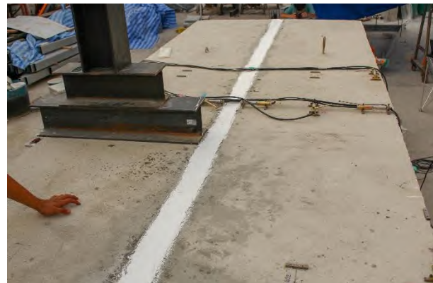
รูปที่ 5.2-14 การทดสอบชิ้นส่วนสะพานสำเร็จรูปคู่แบบสถิติภายหลังการเสริมกำลังด้วยแถบยางพาราอัดแรง ขณะเกิดการแอ่นตัวที่ 2 มิลลิเมตร
