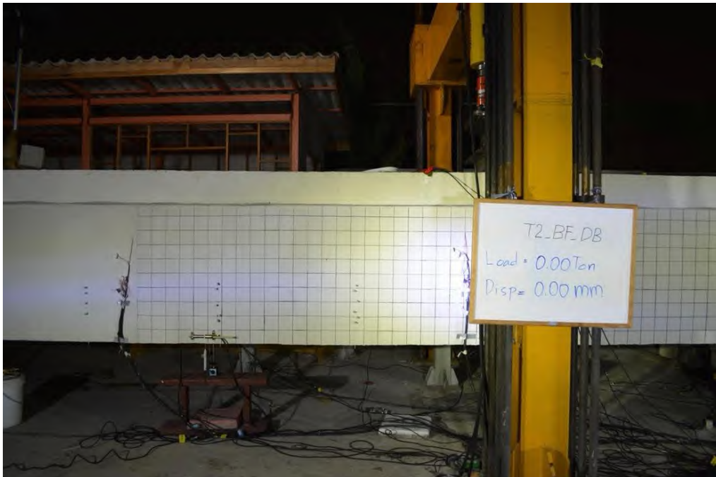
รูปที่ 5.4-1 การทดสอบชิ้นส่วนสะพาน RC T-girder แบบระบบคาน แบบสถิตก่อนการเสริมกำลังด้วยแถบยางพารา อัตราแรงขณะเกิดการแอ่นตัวที่ 0.00 มิลลิเมตร
