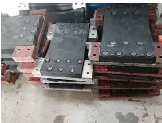
รูปที่ 2.5-4 แผ่นยางพาราที่เจาะรูและประกอบโดยการขันน็อตยึดติดกับ Rubber Grip
