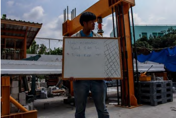
รูปที่ 5.1-22 การทดสอบชิ้นส่วนสะพานสำเร็จรูปเดี่ยวแบบสถิติภายหลังการเสริมกำลังด้วยแถบยางพาราอัดแรง ขณะเกิดการแอ่นตัวที่ 8 มิลลิเมตร
