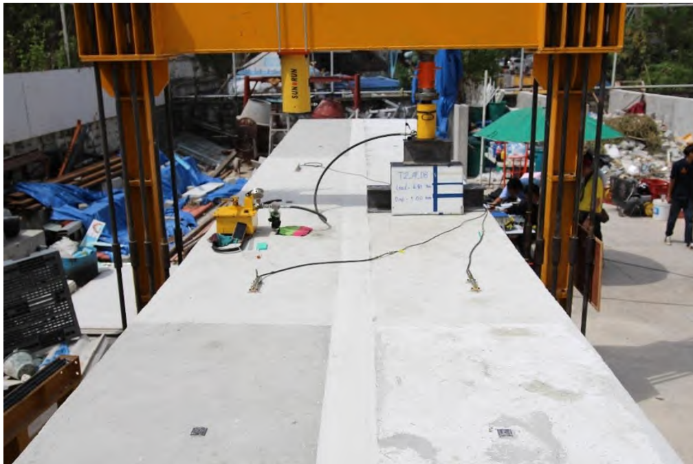
รูปที่ 5.4-33 RC T-Girder แบบระบบคาน หลังเสริมกำลัง ขณะเกิดการแอ่นตัวที่ 1.00 มิลลิเมตร
