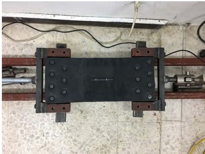
รูปที่ 2.5-5 แผ่นยางพาราประกอบเข้ากับเครื่องดึงยางเพื่อให้ยางมีแรงดึงภายในคงค้าง
