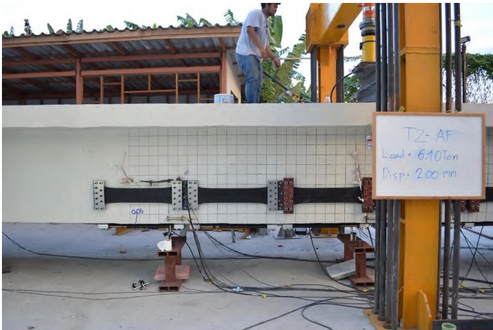
รูปที่ 5.3-25 การทดสอบชิ้นส่วนสะพาน RC T-girder เดี่ยวแบบสลิตภายใต้การเสริมกำลังด้วยแถบยางพาราอัดแรง ขณะเกิดการแอ่นตัวที่ 2.00 มิลลิเมตร
