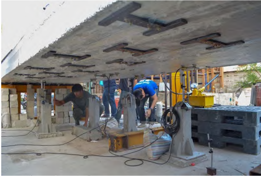
รูปที่ 4.5-4 อุปกรณ์จับยึดแถบยางพาราอัดแรงยึดติดกับชิ้นส่วนสะพานสำเร็จรูป
