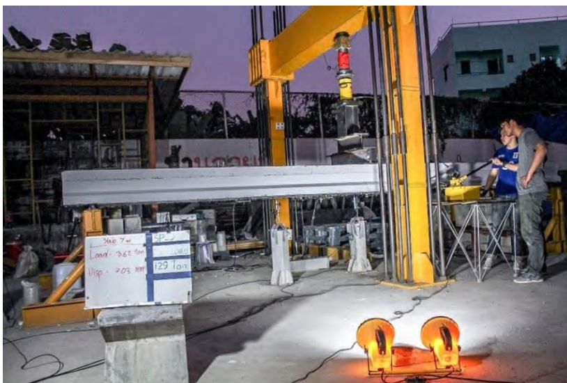
รูปที่ 5.1-8 การทดสอบชิ้นส่วนสะพานสำเร็จรูปเดี่ยวแบบสถิตก่อนการเสริมกำลังด้วยแถบยางพาราอัดแรง ขณะเกิดการแอ่นตัวที่ 7 มิลลิเมตร
