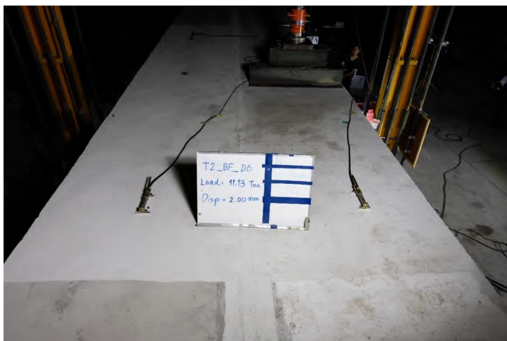
รูปที่ 5.4-10 RC T-Girder แบบระบบคานก่อนเสริมกำลัง ขณะเกิดการแอ่นตัวที่ 2.00 มิลลิเมตร
