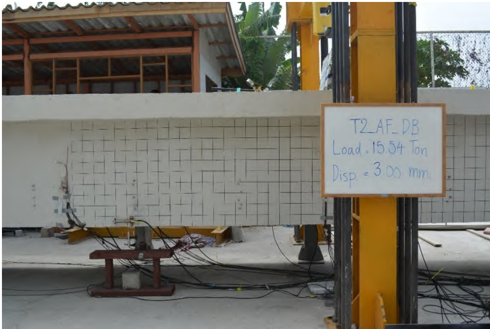
รูปที่ 5.4-25 การทดสอบชิ้นส่วนสะพาน RC T-girder แบบระบบคาน แบบสถิต หลังเสริมกำลังด้วยแถบยางพาราอัด แรงขณะเกิดการแอ่นตัวที่ 3.00 มิลลิเมตร
