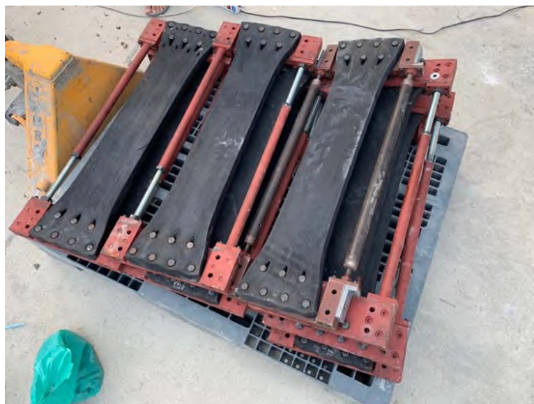
รูปที่ 4.5-3 ชิ้นส่วนยางพาราที่ถูกยึดแล้วที่ระยะยึดเท่ากับ 100 เปอร์เซ็นต์
