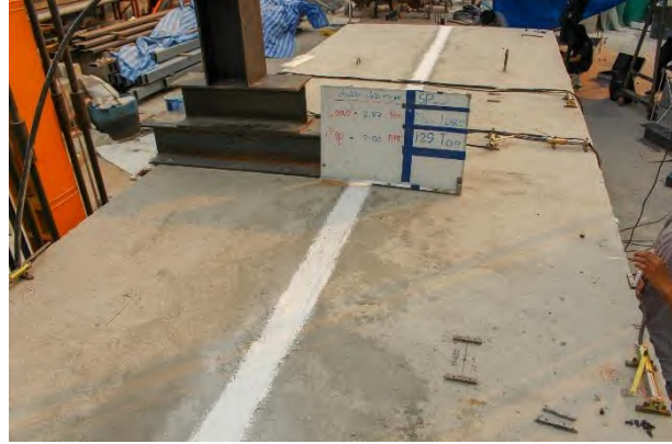
รูปที่ 5.2-2 การทดสอบชิ้นส่วนสะพานสำเร็จรูปคู่แบบสถิตก่อนการเสริมกำลังด้วยแถบยางพาราอัดแรง ขณะเกิดการแอ่นตัวที่ 2 มิลลิเมตร
