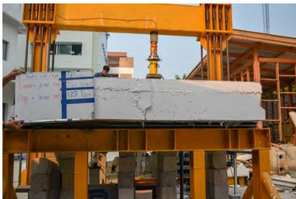
รูปที่ 5.2-8 การทดสอบชิ้นส่วนสะพานสำเร็จรูปคู่แบบสถิตก่อนการเสริมกำลังด้วยแถบยางพาราอัดแรง ขณะเกิดการแอ่นตัวที่ 8 มิลลิเมตร
