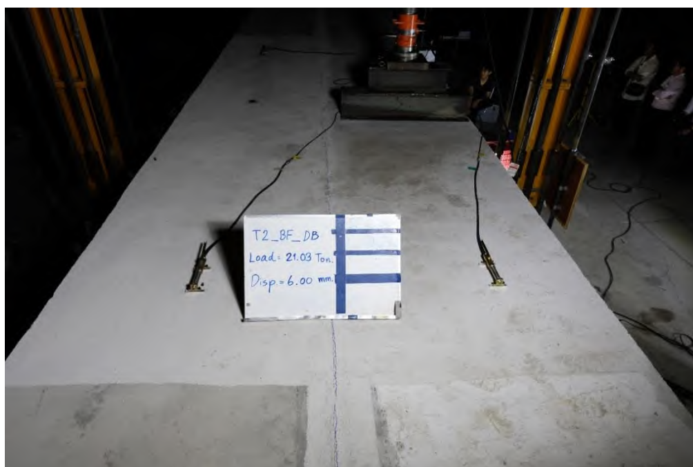
รูปที่ 5.4-14 RC T-Girder แบบระบบคานก่อนเสริมกำลัง ขณะเกิดการแอ่นตัวที่ 6.00 มิลลิเมตร
