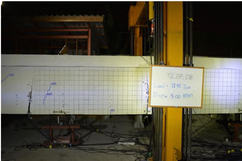
รูปที่ 5.4-6 การทดสอบชิ้นส่วนสะพาน RC T-girder แบบระบบคาน แบบสถิตก่อนการเสริมกำลังด้วยแถบยางพารา อัตราแรงขณะเกิดการแอ่นตัวที่ 5.00 มิลลิเมตร
