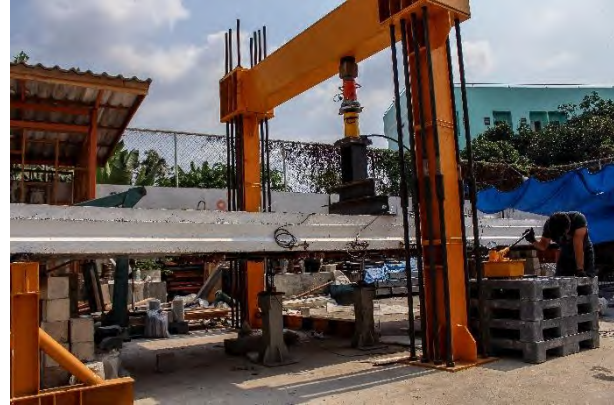
รูปที่ 5.1-22 การทดสอบชิ้นส่วนสะพานสำเร็จรูปเดี่ยวแบบสถิติภายหลังการเสริมกำลังด้วยแถบยางพาราอัดแรง ขณะเกิดการแอ่นตัวที่ 8 มิลลิเมตร
