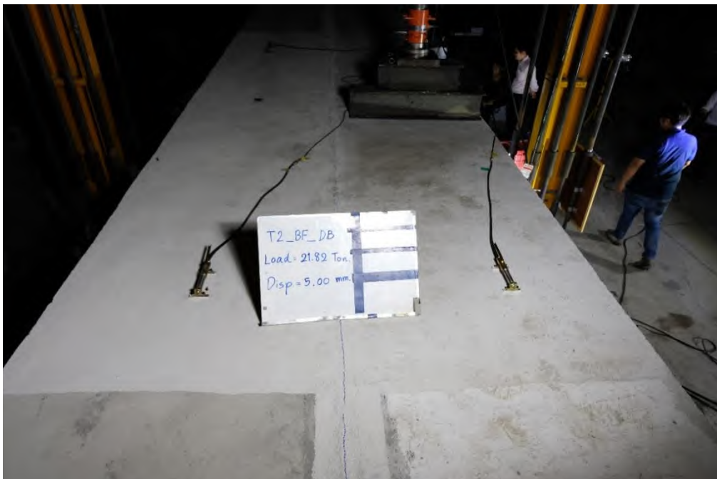
รูปที่ 5.4-13 RC T-Girder แบบระบบคานก่อนเสริมกำลัง ขณะเกิดการแอ่นตัวที่ 5.00 มิลลิเมตร
