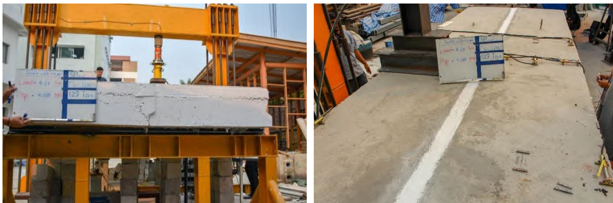
รูปที่ 5.2-4 การทดสอบชิ้นส่วนสะพานสำเร็จรูปคู่แบบสถิตก่อนการเสริมกำลังด้วยแถบยางพาราอัดแรง ขณะเกิดการแอ่นตัวที่ 4 มิลลิเมตร
