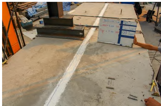
รูปที่ 5.2-7 การทดสอบชิ้นส่วนสะพานสำเร็จรูปคู่แบบสถิตก่อนการเสริมกำลังด้วยแถบยางพาราอัดแรง ขณะเกิดการแอ่นตัวที่ 7 มิลลิเมตร
