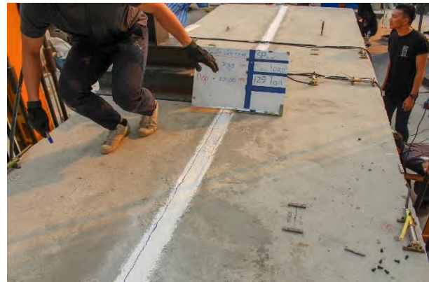
รูปที่ 5.2-13 การทดสอบชิ้นส่วนสะพานสำเร็จรูปคู่แบบสถิติภายหลังการเสริมกำลังด้วยแถบยางพาราอัดแรง ขณะเกิดการแอ่นตัวที่ 0 มิลลิเมตร
