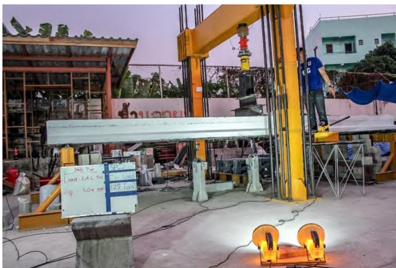
รูปที่ 5.1-3 การทดสอบชิ้นส่วนสะพานสำเร็จรูปเดี่ยวแบบสถิติก่อนการเสริมกำลังด้วยแถบยางพาราอัดแรง ขณะเกิดการแอ่นตัวที่ 2 มิลลิเมตร
