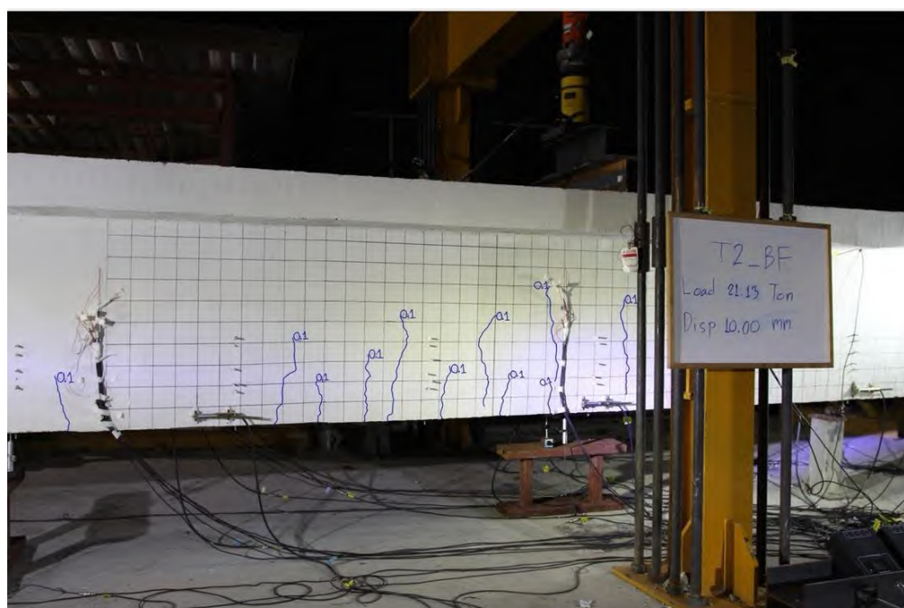
รูปที่ 5.3-12 การทดสอบชิ้นส่วนสะพาน RC T-girder เดี่ยวแบบสลิตก่อนการเสริมกำลังด้วยแถบยางพาราอัดแรง ขณะเกิดการแอ่นตัวที่ 10.00 มิลลิเมตร
