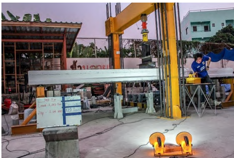
รูปที่ 5.1-2 การทดสอบชิ้นส่วนสะพานสำเร็จรูปแบบเดี่ยวยแบบสถิติก่อนการเสริมกำลังด้วยแถบยางพาราอัดแรง ขณะเกิดการแอ่นตัวที่ 1 มิลลิเมตร
