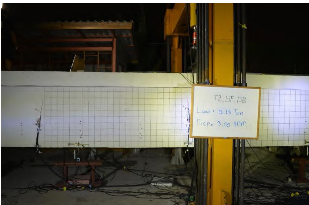
รูปที่ 5.4-4 การทดสอบชิ้นส่วนสะพาน RC T-girder แบบระบบคาน แบบสถิตก่อนการเสริมกำลังด้วยแถบยางพารา อัตราแรงขณะเกิดการแอ่นตัวที่ 3.00 มิลลิเมตร
