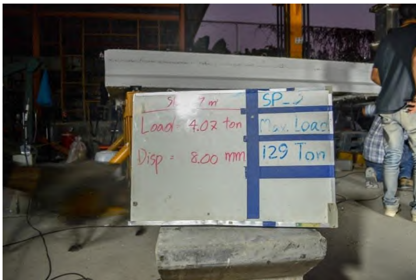
รูปที่ 5.1-9 การทดสอบชิ้นส่วนสะพานสำเร็จรูปเดี่ยวแบบสลิตก่อนการเสริมกำลังด้วยแถบยางพาราอัดแรง ขณะเกิดการแอ่นตัวที่ 8 มิลลิเมตร
