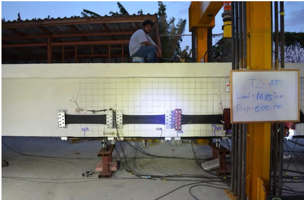
รูปที่ 5.3-29 การทดสอบชิ้นส่วนสะพาน RC T-girder เดี่ยวแบบสลิตภายใต้การเสริมกำลังด้วยแถบยางพาราอัดแรง ขณะเกิดการแอ่นตัวที่ 6.00 มิลลิเมตร
