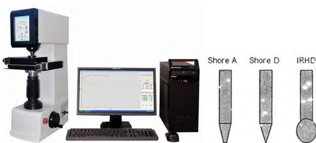
เครื่องวัดความแข็งและลักษณะของหัวกดแบบต่างๆ
