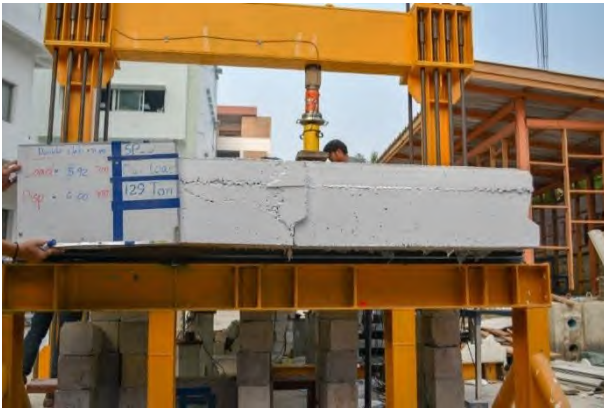
รูปที่ 5.2-6 การทดสอบชิ้นส่วนสะพานสำเร็จรูปคู่แบบสถิตก่อนการเสริมกำลังด้วยแถบยางพาราอัดแรง ขณะเกิดการแอ่นตัวที่ 6 มิลลิเมตร
