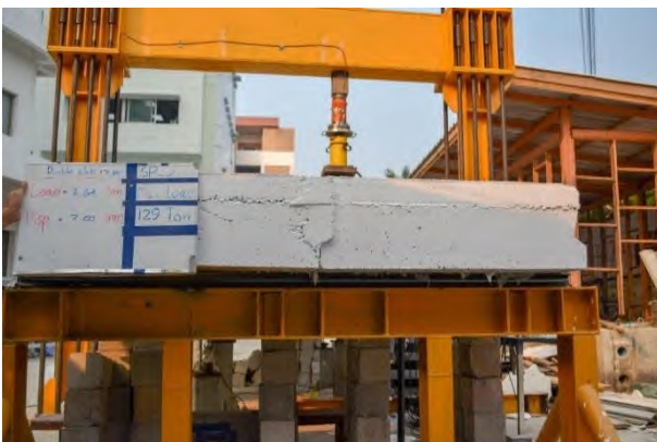
รูปที่ 5.2-7 การทดสอบชิ้นส่วนสะพานสำเร็จรูปคู่แบบสถิตก่อนการเสริมกำลังด้วยแถบยางพาราอัดแรง ขณะเกิดการแอ่นตัวที่ 7 มิลลิเมตร
