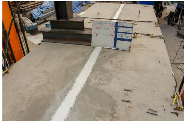
รูปที่ 5.2-3 การทดสอบชิ้นส่วนสะพานสำเร็จรูปคู่แบบสถิตก่อนการเสริมกำลังด้วยแถบยางพาราอัดแรง ขณะเกิดการแอ่นตัวที่ 3 มิลลิเมตร
