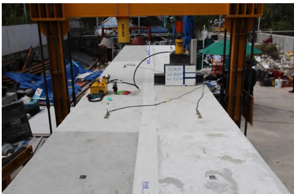
รูปที่ 5.4-39 RC T-Girder แบบระบบคาน หลังเสริมกำลัง ขณะเกิดการแอ่นตัวที่ 7.00 มิลลิเมตร
