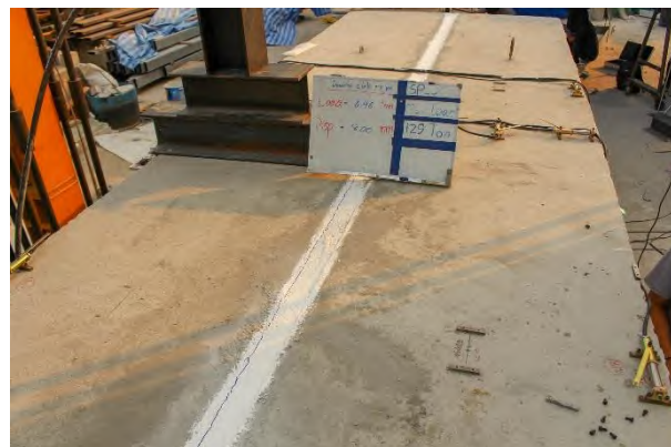
รูปที่ 5.2-8 การทดสอบชิ้นส่วนสะพานสำเร็จรูปคู่แบบสถิตก่อนการเสริมกำลังด้วยแถบยางพาราอัดแรง ขณะเกิดการแอ่นตัวที่ 8 มิลลิเมตร
