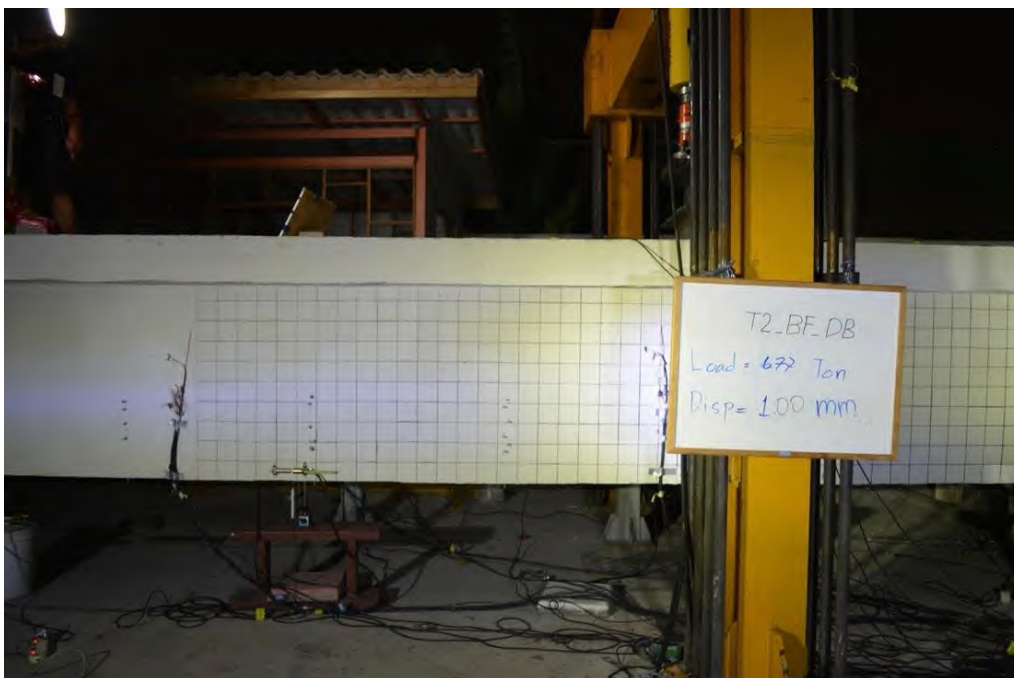
รูปที่ 5.4-2 การทดสอบชิ้นส่วนสะพาน RC T-girder แบบระบบคาน แบบสถิตก่อนการเสริมกำลังด้วยแถบยางพารา อัตราแรงขณะเกิดการแอ่นตัวที่ 1.00 มิลลิเมตร
