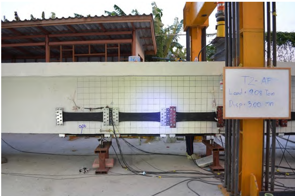
รูปที่ 5.3-26 การทดสอบชิ้นส่วนสะพาน RC T-girder เดี่ยวแบบสลิตภายใต้การเสริมกำลังด้วยแถบยางพาราอัดแรง ขณะเกิดการแอ่นตัวที่ 3.00 มิลลิเมตร
