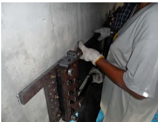
รูปที่ 4.5-6 ขั้นตอนการปลดล๊อคอุปกรณ์จับยึดแฉวยางพาราอัดแรงเพื่อให้ยางพาราถ่ายแรงเข้าสู่ชิ้นส่วน
