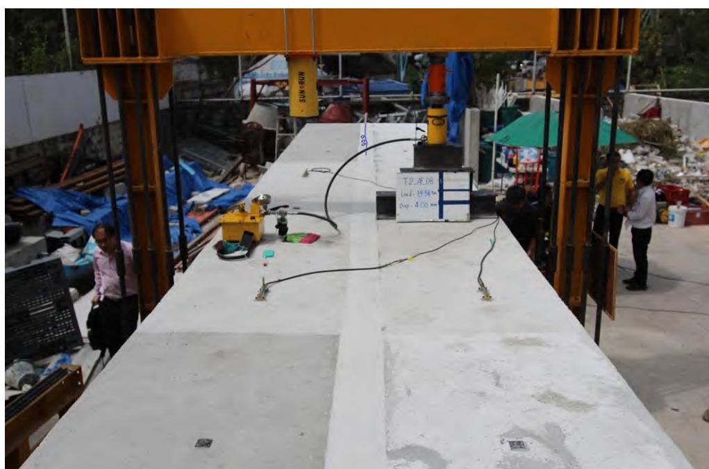
รูปที่ 5.4-36 RC T-Girder แบบระบบคาน หลังเสริมกำลัง ขณะเกิดการแอ่นตัวที่ 4.00 มิลลิเมตร
