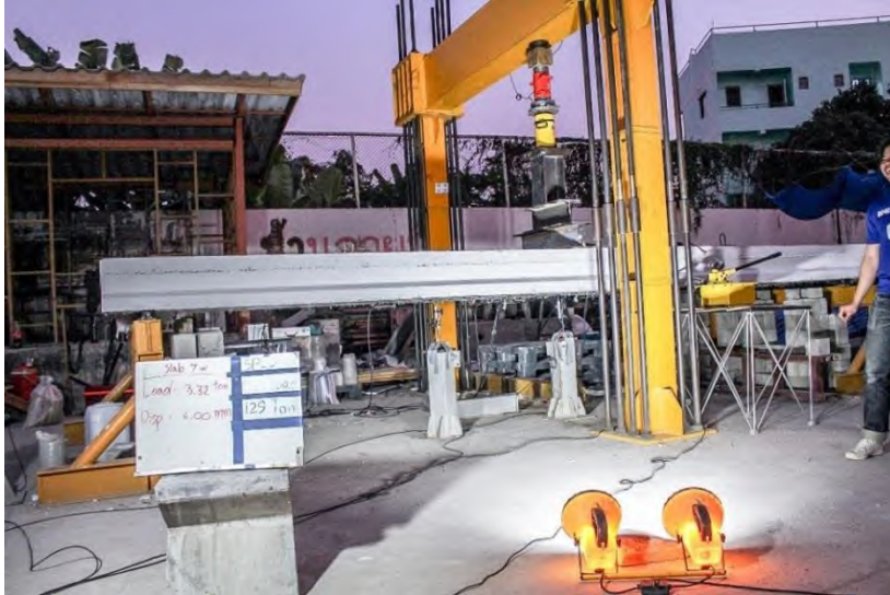
รูปที่ 5.1-7 การทดสอบชิ้นส่วนสะพานสำเร็จรูปเดี่ยวแบบสถิตก่อนการเสริมกำลังด้วยแถบยางพาราอัดแรง ขณะเกิดการแอ่นตัวที่ 6 มิลลิเมตร
