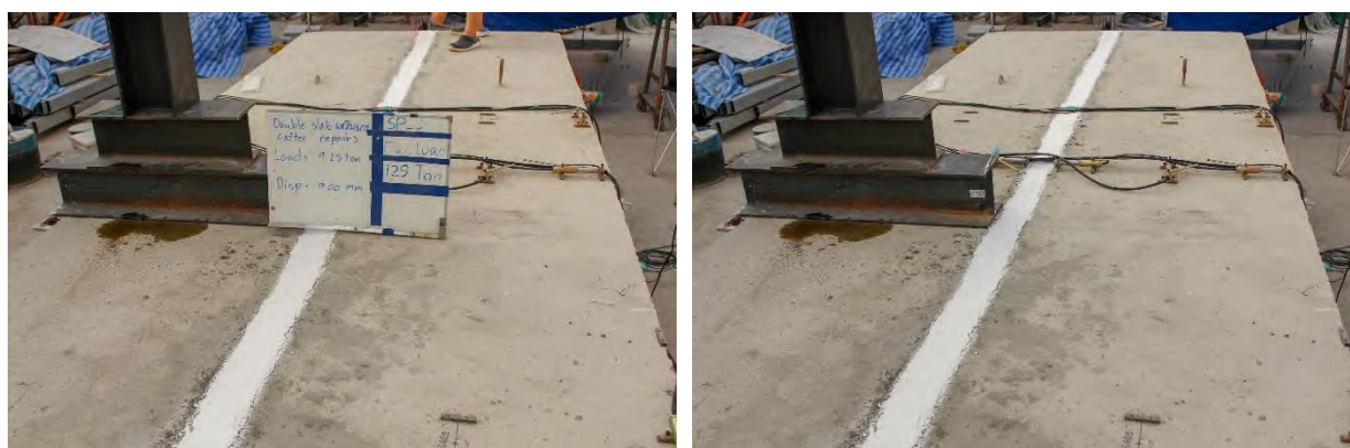
รูปที่ 5.2-20 การทดสอบชิ้นส่วนสะพานสำเร็จรูปคู่แบบสถิติภายหลังการเสริมกำลังด้วยแถบยางพาราอัดแรง
