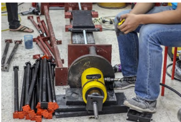
รูปที่ 4.5-2 ขั้นตอนการดึงแถบยางพาราอัดแรงที่ระดับความเครียดเท่ากับ 100 เปอร์เซ็นต์
