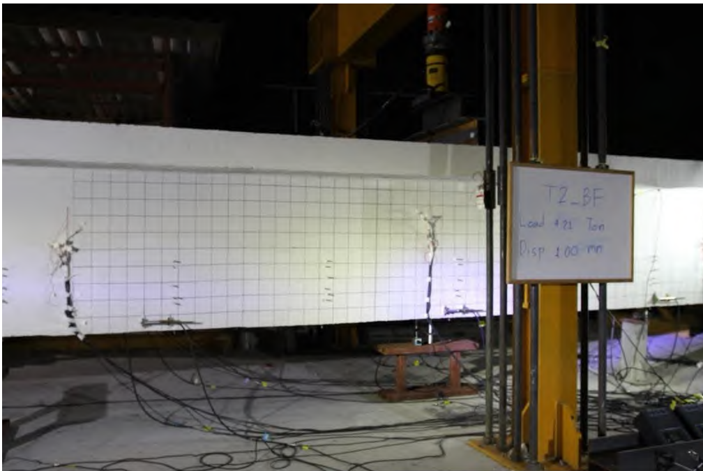
รูปที่ 5.3-3 การทดสอบชิ้นส่วนสะพาน RC T-girder เดี่ยวแบบสลิตก่อนการเสริมกำลังด้วยแถบยางพาราอัดแรง ขณะเกิดการแอนตัวที่ 1.00 มิลลิเมตร
