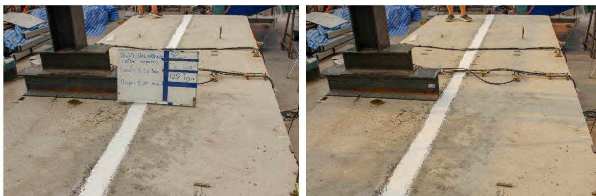
รูปที่ 5.2-15 การทดสอบชิ้นส่วนสะพานสำเร็จรูปคู่แบบสถิติภายหลังการเสริมกำลังด้วยแถบยางพาราอัดแรง ขณะเกิดการแอ่นตัวที่ 3 มิลลิเมตร
