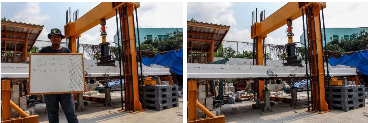
รูปที่ 5.1-15 การทดสอบชิ้นส่วนสะพานสำเร็จรูปเดี่ยวแบบสถิติภายหลังการเสริมกำลังด้วยแถบยางพาราอัดแรง ขณะเกิดการแอ่นตัวที่ 1 มิลลิเมตร
