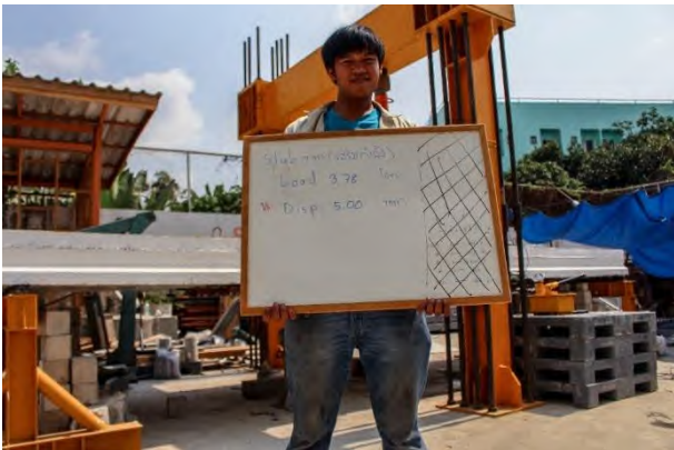
รูปที่ 5.1-19 การทดสอบชิ้นส่วนสะพานสำเร็จรูปเดี่ยวแบบสถิติภายหลังการเสริมกำลังด้วยแถบยางพาราอัดแรง ขณะเกิดการแอ่นตัวที่ 5 มิลลิเมตร
