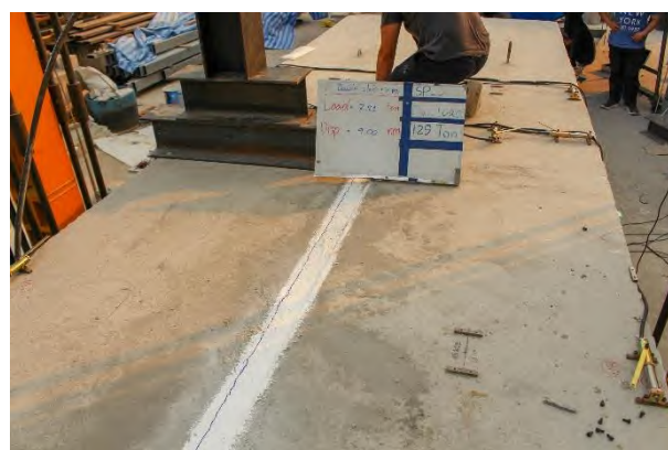
รูปที่ 5.2-9 การทดสอบชิ้นส่วนสะพานสำเร็จรูปคู่แบบสถิตก่อนการเสริมกำลังด้วยแถบยางพาราอัดแรง ขณะเกิดการแอ่นตัวที่ 9 มิลลิเมตร
