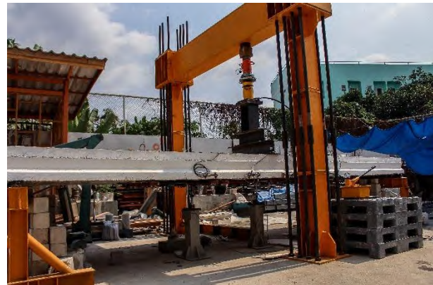
รูปที่ 5.1-23 การทดสอบชิ้นส่วนสะพานสำเร็จรูปเดี่ยวแบบสถิติภายหลังการเสริมกำลังด้วยแถบยางพาราอัดแรง ขณะเกิดการแอ่นตัวที่ 9 มิลลิเมตร
