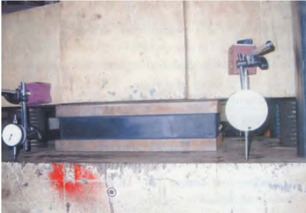
เครื่องทดสอบการกด (Compression Test Machine) (จิตพันธ์, 2547)
