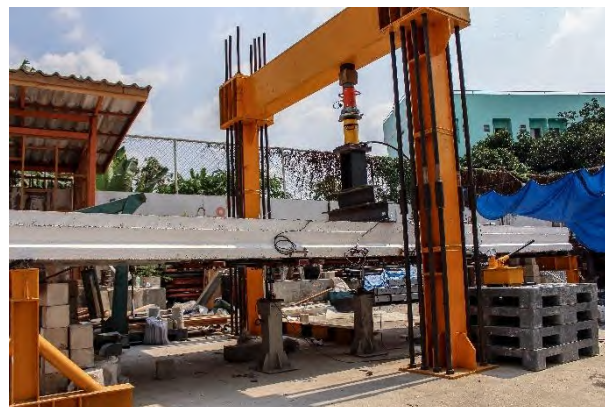
รูปที่ 5.1-20 การทดสอบชิ้นส่วนสะพานสำเร็จรูปเดี่ยวแบบสถิติภายหลังการเสริมกำลังด้วยแถบยางพาราอัดแรง ขณะเกิดการแอ่นตัวที่ 6 มิลลิเมตร
