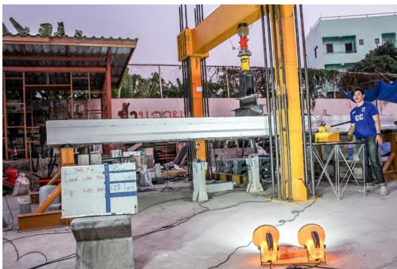
รูปที่ 5.1-4 การทดสอบชิ้นส่วนสะพานสำเร็จรูปเดี่ยวแบบสถิติก่อนการเสริมกำลังด้วยแถบยางพาราอัดแรง ขณะเกิดการแอ่นตัวที่ 3 มิลลิเมตร
