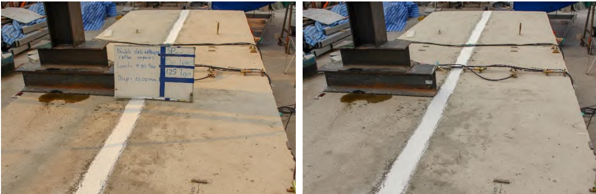
รูปที่ 5.2-21 การทดสอบชิ้นส่วนสะพานสำเร็จรูปคู่แบบสถิติภายหลังการเสริมกำลังด้วยแถบยางพาราอัดแรง ขณะเกิดการแอ่นตัวที่ 10 มิลลิเมตร
