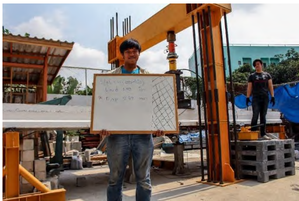
รูปที่ 5.1-16 การทดสอบชิ้นส่วนสะพานสำเร็จรูปเดี่ยวแบบสถิติภายหลังการเสริมกำลังด้วยแถบยางพาราอัดแรง ขณะเกิดการแอ่นตัวที่ 2 มิลลิเมตร
