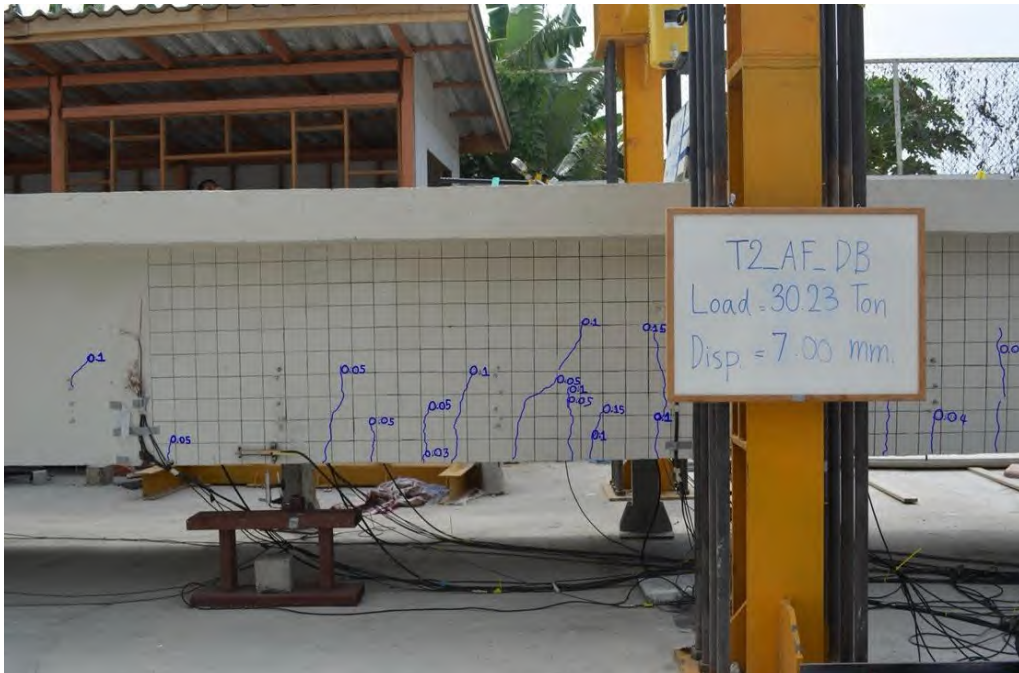
รูปที่ 5.4-29 การทดสอบชิ้นส่วนสะพาน RC T-girder แบบระบบคาน แบบสลิต หลังเสริมกำลังด้วยแถบยางพาราอัด แรงขณะเกิดการแอ่นตัวที่ 7.00 มิลลิเมตร
