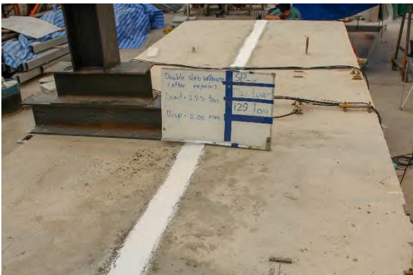
รูปที่ 5.2-14 การทดสอบชิ้นส่วนสะพานสำเร็จรูปคู่แบบสถิติภายหลังการเสริมกำลังด้วยแถบยางพาราอัดแรง ขณะเกิดการแอ่นตัวที่ 2 มิลลิเมตร
