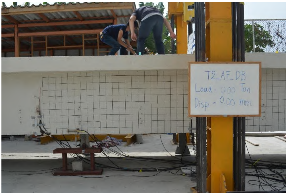
รูปที่ 5.4-22 การทดสอบชิ้นส่วนสะพาน RC T-girder แบบระบบคาน แบบสถิต หลังเสริมกำลังด้วยแถบยางพาราอัด
