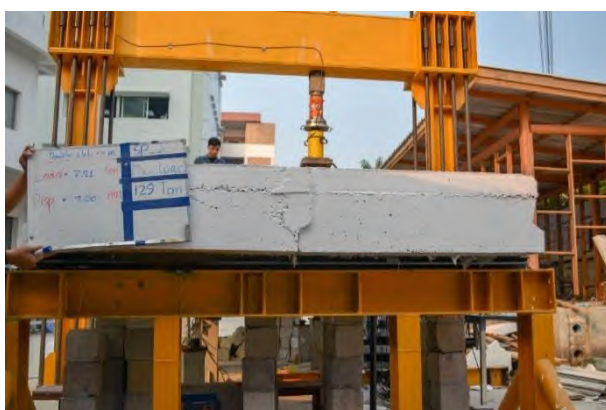
รูปที่ 5.2-9 การทดสอบชิ้นส่วนสะพานสำเร็จรูปคู่แบบสถิตก่อนการเสริมกำลังด้วยแถบยางพาราอัดแรง ขณะเกิดการแอ่นตัวที่ 9 มิลลิเมตร
