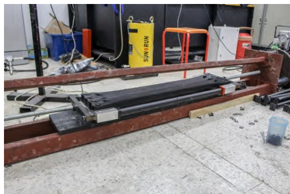
รูปที่ 4.5-2 ขั้นตอนการดึงแถบยางพาราอัดแรงที่ระดับความเครียดเท่ากับ 100 เปอร์เซ็นต์
