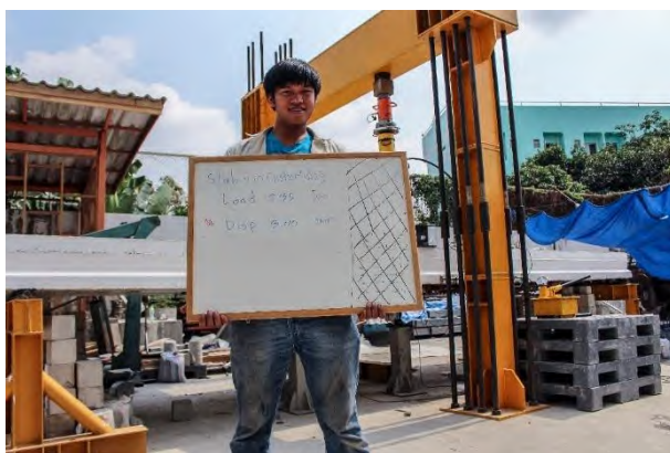
รูปที่ 5.1-17 การทดสอบชิ้นส่วนสะพานสำเร็จรูปเดี่ยวแบบสถิติภายหลังการเสริมกำลังด้วยแถบยางพาราอัดแรง ขณะเกิดการแอ่นตัวที่ 3 มิลลิเมตร
