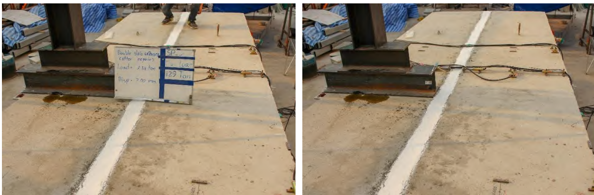
รูปที่ 5.2-18 การทดสอบชิ้นส่วนสะพานสำเร็จรูปคู่แบบสถิติภายหลังการเสริมกำลังด้วยแถบยางพาราอัดแรง
