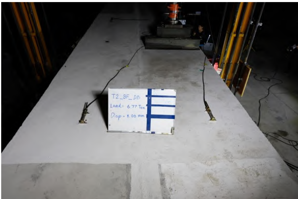
รูปที่ 5.4-9 RC T-Girder แบบระบบคานก่อนเสริมกำลัง ขณะเกิดการแอ่นตัวที่ 1.00 มิลลิเมตร
