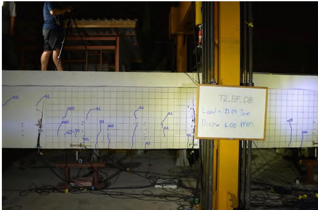
รูปที่ 5.4-7 การทดสอบชิ้นส่วนสะพาน RC T-girder แบบระบบคาน แบบสถิตก่อนการเสริมกำลังด้วยแถบยางพารา อัตราแรงขณะเกิดการแอ่นตัวที่ 6.00 มิลลิเมตร
