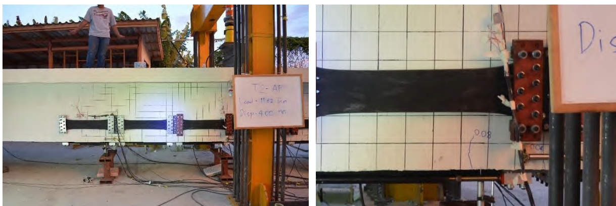
รูปที่ 5.3-39 การทดสอบ RC T-Girder เดี่ยวแบบสถิติภายหลังการเสริมกำลังด้วยวัสดุยางพารา ขณะเกิดการแอ่นตัวที่ 4 มิลลิเมตร (ไม่เกิดการแตกร้าว)
