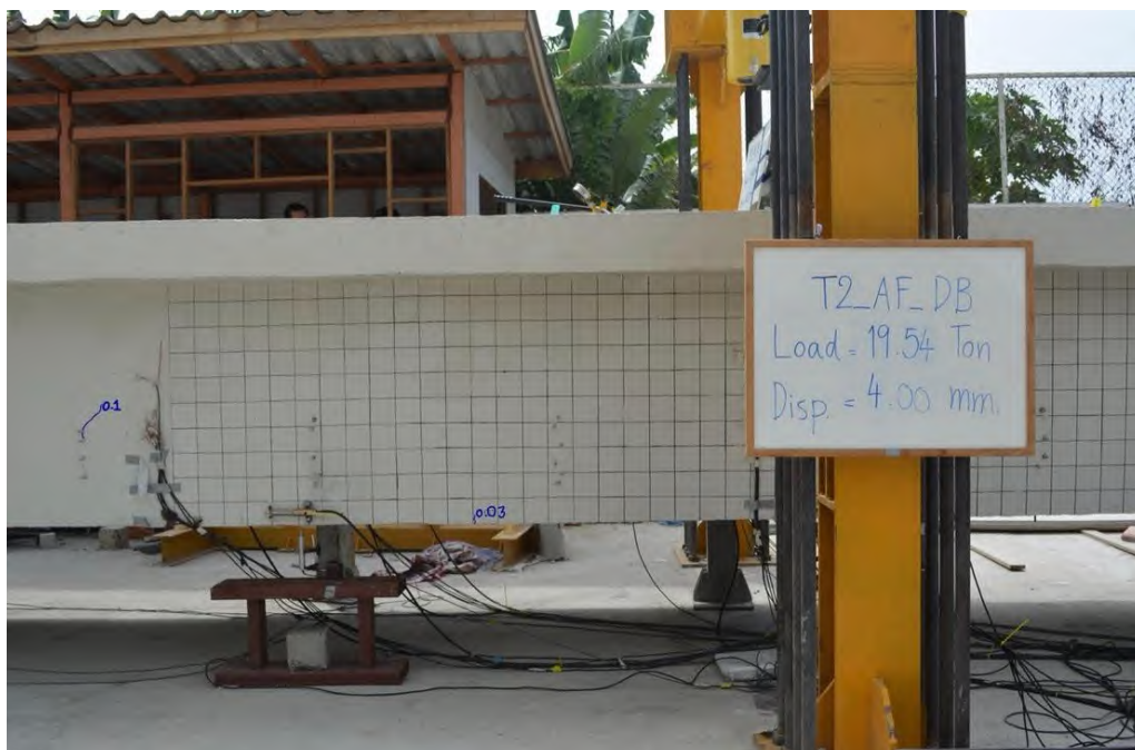
รูปที่ 5.4-26 การทดสอบชิ้นส่วนสะพาน RC T-girder แบบระบบคาน แบบสถิต หลังเสริมกำลังด้วยแถบยางพาราอัด แรงขณะเกิดการแอ่นตัวที่ 4.00 มิลลิเมตร
