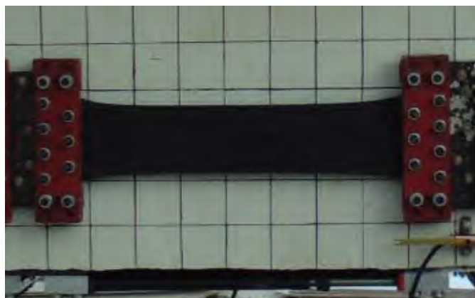
รูปที่ 4.5-6 ขั้นตอนการปลดล๊อคอุปกรณ์จับยึดแฉวยางพาราอัดแรงเพื่อให้ยางพาราถ่ายแรงเข้าสู่ชิ้นส่วน
