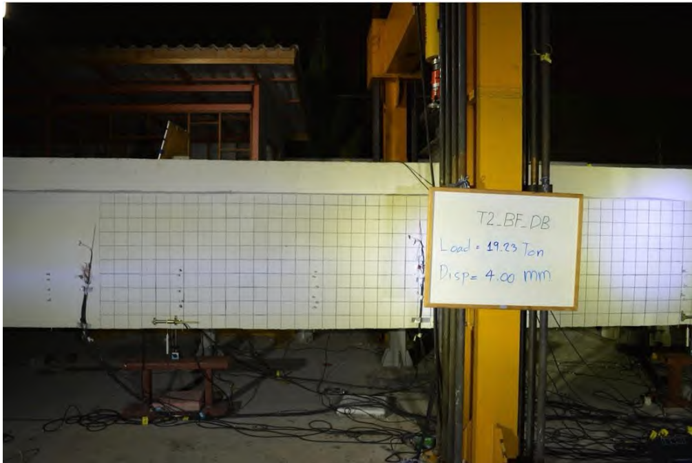
รูปที่ 5.4-5 การทดสอบชิ้นส่วนสะพาน RC T-girder แบบระบบคาน แบบสถิตก่อนการเสริมกำลังด้วยแถบยางพารา อัตราแรงขณะเกิดการแอ่นตัวที่ 4.00 มิลลิเมตร
