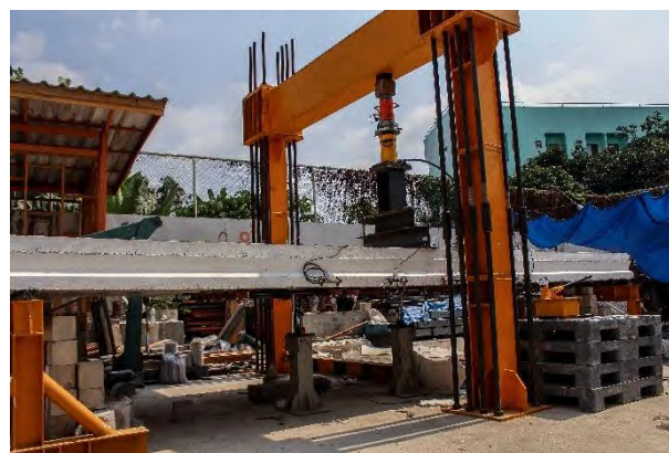
รูปที่ 5.1-21 การทดสอบชิ้นส่วนสะพานสำเร็จรูปเดี่ยวแบบสถิติภายหลังการเสริมกำลังด้วยแถบยางพาราอัดแรง ขณะเกิดการแอ่นตัวที่ 7 มิลลิเมตร
