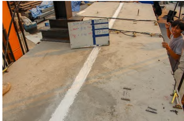
รูปที่ 5.2-6 การทดสอบชิ้นส่วนสะพานสำเร็จรูปคู่แบบสถิตก่อนการเสริมกำลังด้วยแถบยางพาราอัดแรง ขณะเกิดการแอ่นตัวที่ 6 มิลลิเมตร
