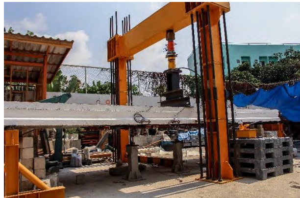
รูปที่ 5.1-19 การทดสอบชิ้นส่วนสะพานสำเร็จรูปเดี่ยวแบบสถิติภายหลังการเสริมกำลังด้วยแถบยางพาราอัดแรง ขณะเกิดการแอ่นตัวที่ 5 มิลลิเมตร
