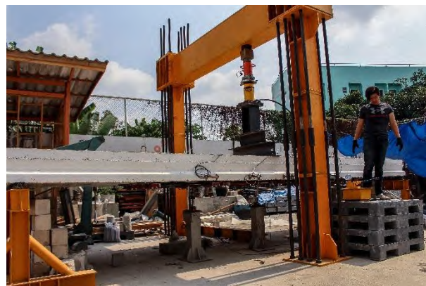
รูปที่ 5.1-16 การทดสอบชิ้นส่วนสะพานสำเร็จรูปเดี่ยวแบบสถิติภายหลังการเสริมกำลังด้วยแถบยางพาราอัดแรง ขณะเกิดการแอ่นตัวที่ 2 มิลลิเมตร
