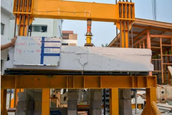
รูปที่ 5.2-2 การทดสอบชิ้นส่วนสะพานสำเร็จรูปคู่แบบสถิตก่อนการเสริมกำลังด้วยแถบยางพาราอัดแรง ขณะเกิดการแอ่นตัวที่ 2 มิลลิเมตร
