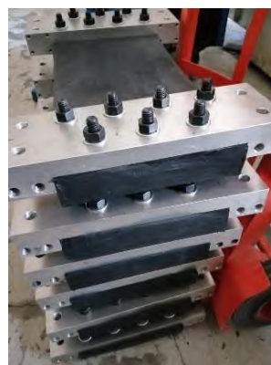
รูปที่ 2.5-4 แผ่นยางพาราที่เจาะรูและประกอบโดยการขันน็อตยึดติดกับ Rubber Grip
