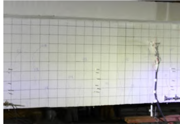
รูปที่ 5.3-18 การทดสอบขณะ RC T-girder เกิดการแตกร้าวเท่ากับ 15 มิลลิเมตร
