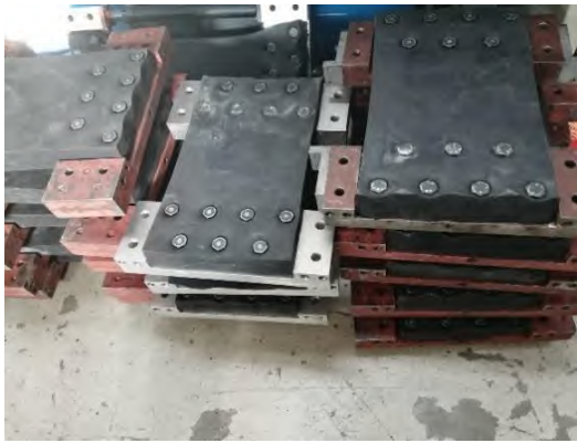
รูปที่ 3.2-2 แผ่นยางพาราที่เจาะรูและประกอบโดยการขันน็อตยึดติดกับ Rubber Grip
