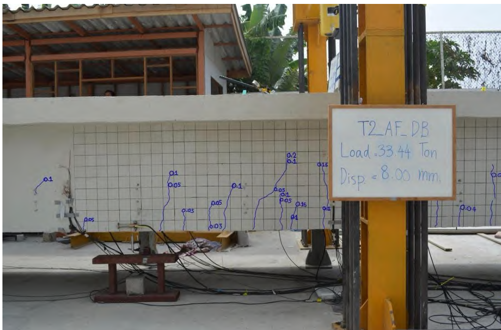
รูปที่ 5.4-30 การทดสอบชิ้นส่วนสะพาน RC T-girder แบบระบบคาน แบบสลิต หลังเสริมกำลังด้วยแถบยางพาราอัด แรงขณะเกิดการแอ่นตัวที่ 8.00 มิลลิเมตร
