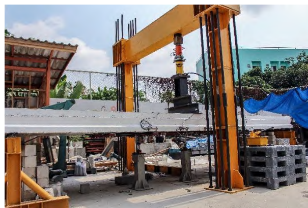
รูปที่ 5.1-17 การทดสอบชิ้นส่วนสะพานสำเร็จรูปเดี่ยวแบบสถิติภายหลังการเสริมกำลังด้วยแถบยางพาราอัดแรง ขณะเกิดการแอ่นตัวที่ 3 มิลลิเมตร
