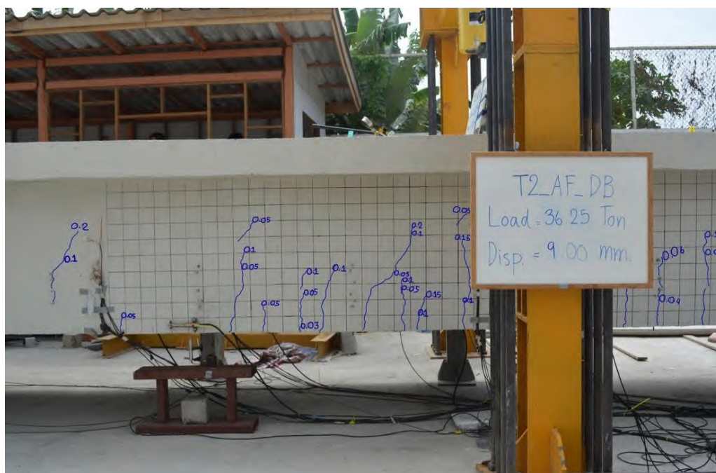
รูปที่ 5.4-31 การทดสอบชิ้นส่วนสะพาน RC T-girder แบบระบบคาน แบบสลิต หลังเสริมกำลังด้วยแถบยางพาราอัดแรงขณะเกิดการแอ่นตัวที่ 9.00 มิลลิเมตร
