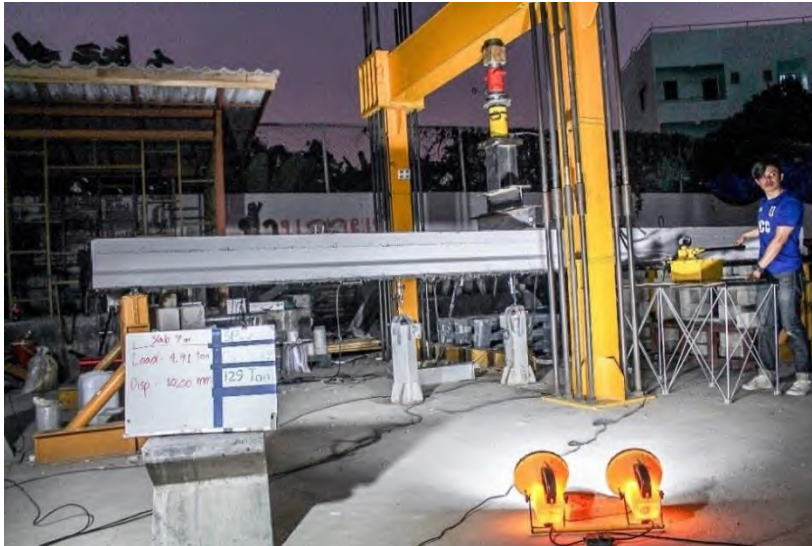
รูปที่ 5.1-11 การทดสอบชิ้นส่วนสะพานสำเร็จรูปเดี่ยวแบบสถิตก่อนการเสริมกำลังด้วยแถบยางพาราอัดแรง ขณะเกิดการแอ่นตัวที่ 10 มิลลิเมตร
