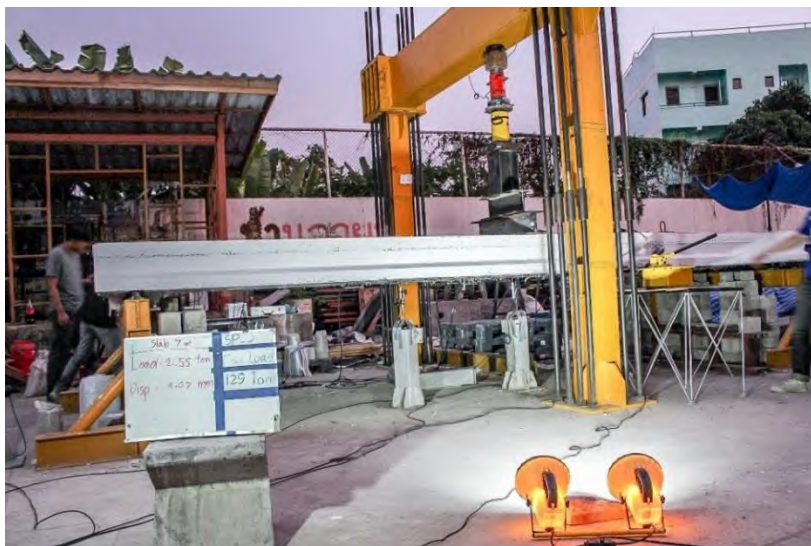
รูปที่ 5.1-5 การทดสอบชิ้นส่วนสะพานสำเร็จรูปเดี่ยวแบบสลิตก่อนการเสริมกำลังด้วยแถบยางพาราอัดแรง ขณะเกิดการแอ่นตัวที่ 4 มิลลิเมตร
