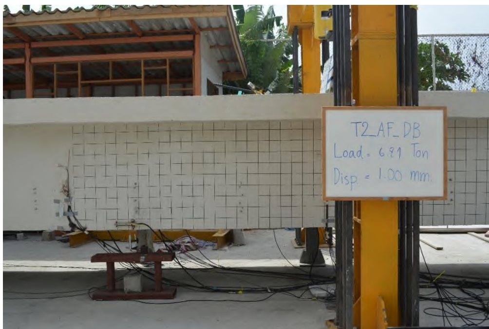
รูปที่ 5.4-23 การทดสอบชิ้นส่วนสะพาน RC T-girder แบบระบบคาน แบบสลิต หลังเสริมกำลังด้วยแถบยางพาราอัด แรงขณะเกิดการแอ่นตัวที่ 1.00 มิลลิเมตร
