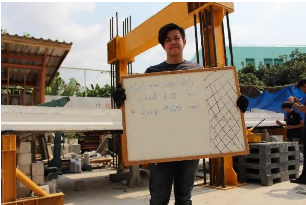
รูปที่ 5.1-23 การทดสอบชิ้นส่วนสะพานสำเร็จรูปเดี่ยวแบบสถิติภายหลังการเสริมกำลังด้วยแถบยางพาราอัดแรง ขณะเกิดการแอ่นตัวที่ 9 มิลลิเมตร
