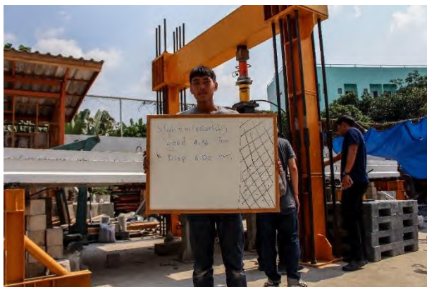
รูปที่ 5.1-20 การทดสอบชิ้นส่วนสะพานสำเร็จรูปเดี่ยวแบบสถิติภายหลังการเสริมกำลังด้วยแถบยางพาราอัดแรง ขณะเกิดการแอ่นตัวที่ 6 มิลลิเมตร
