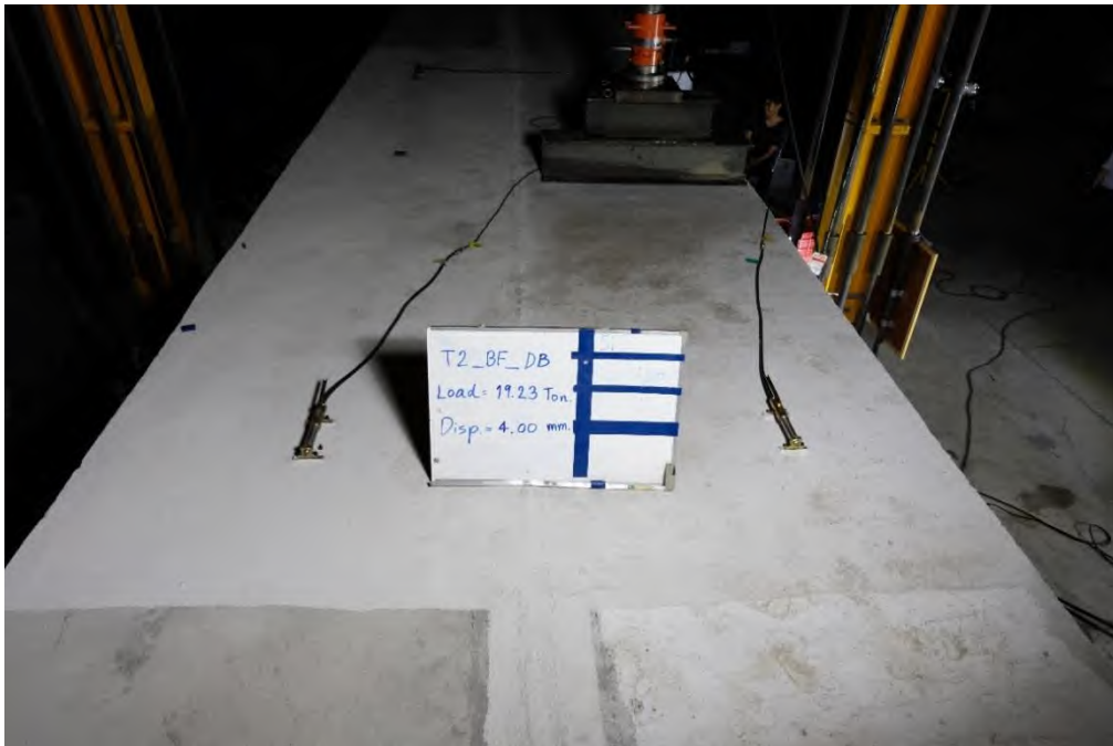
รูปที่ 5.4-12 RC T-Girder แบบระบบคานก่อนเสริมกำลัง ขณะเกิดการแอ่นตัวที่ 4.00 มิลลิเมตร
