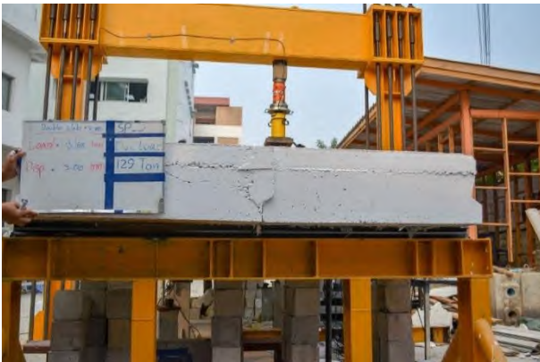
รูปที่ 5.2-3 การทดสอบชิ้นส่วนสะพานสำเร็จรูปคู่แบบสถิตก่อนการเสริมกำลังด้วยแถบยางพาราอัดแรง ขณะเกิดการแอ่นตัวที่ 3 มิลลิเมตร
